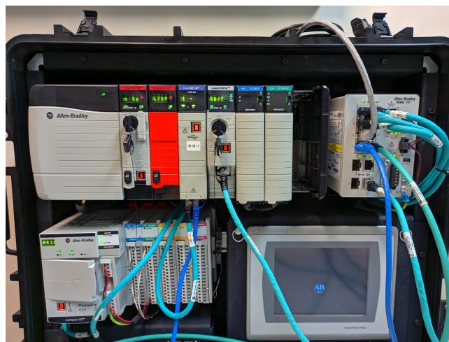
Figura 3.22: Arquitetura tradicional de Hardware - Cartões de Entrada/Saída no mesmo rack do CLP. Fonte: Autor.
