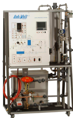
Figura 2.1: Imagem da planta em uma versão mais nova, mas muito similar à utilizada, com toda sua instrumentação empregada no projeto. Fonte: [3]
