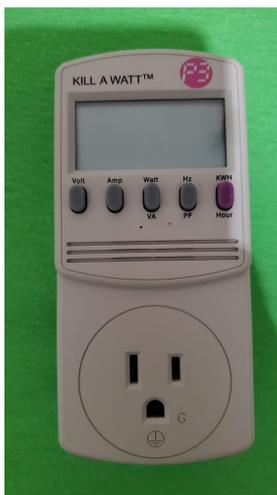
Figura 22 – Potenciômetro utilizado para medir o gasto energético total do sistema. Autoria própria.
