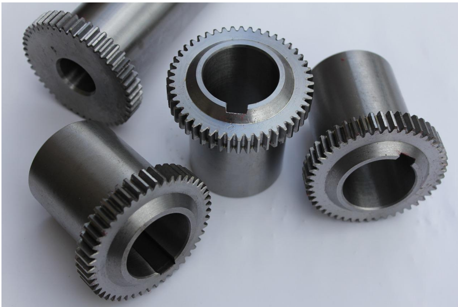
Figura 2.6: Peças de aço produzidas por brochamento. Fonte: Pixabay (2016b)
