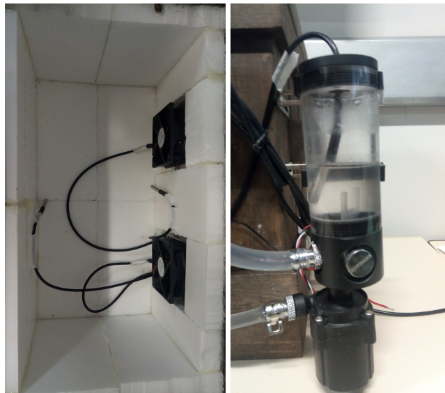
Figura 4.1: Localização dos cinco sensores de temperatura; quatro na parte interna da caixa e um dentro do reservatório de água, no circuito hidráulico.
