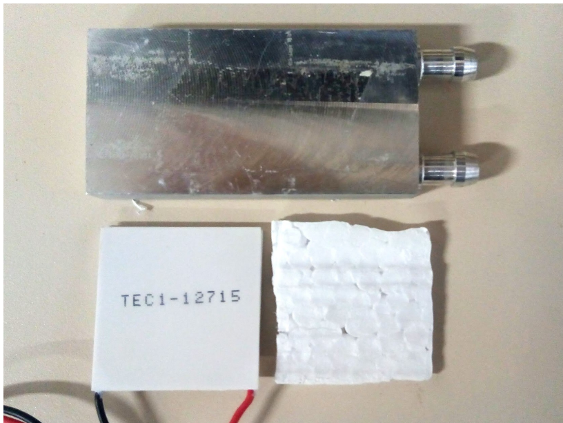
Figura 4.3: Bloco de água, módulo Peltier e folha de isopor usados na montagem do protótipo.
