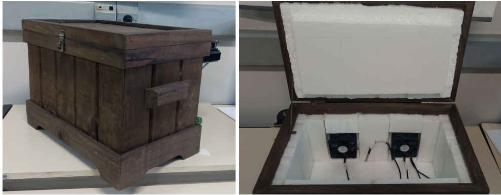
Figura 3.1: Caixa de madeira componente do protótipo de câmara térmica, revestida com isopor de alta densidade e os dois conjuntos de dissipador e ventoinha.
