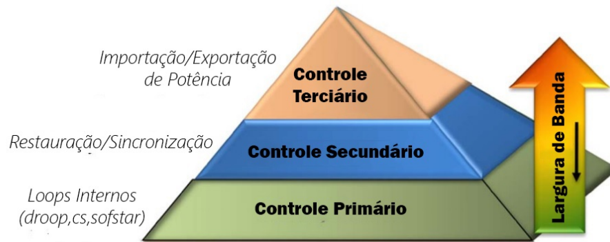
Figura 6 – Níveis de controle hierárquico de uma microrrede
