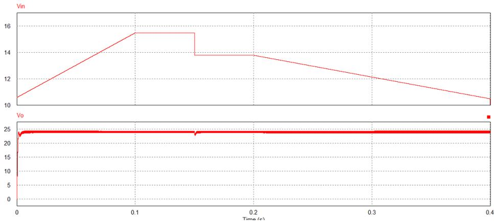
Figura 74 – Curvas da simulação do controle de tensão com variação na tensão da bateria.
