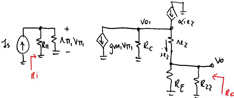
$$\rightarrow v_{\pi 1} = R_{11} // r_{\pi 1} \cdot i_S = 4,162 \text{ kV/A} \cdot i_S$$
