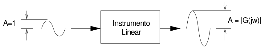
Figura 3.3: Obtenção prática da função de transferência de um instrumento linear (ou linearizado).
