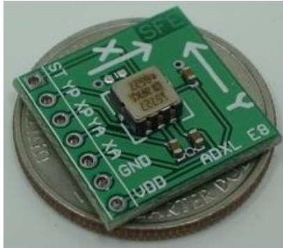
Foto de um típico circuito integrado acelerômetro MEMS de baixo custo já soldado a uma placa de circuito impresso.
