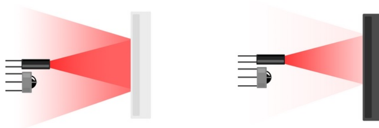
Figura 7.1: Reflexão da luz de um sensor infra vermelho para uma superfície branca e uma superfície preta.
