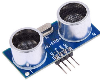
Figura 7.3: Sensor ultrassônico HC-SR04.
