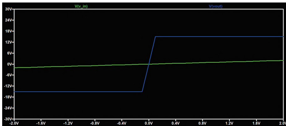
Figura 6.3.4: Simulação do circuito da Fig. 6.3.2: tensão variante da fonte V1 em verde ( V(v_{in}) ) e tensão na saída do amplificador operacional em azul ( V(v_{out}) )
