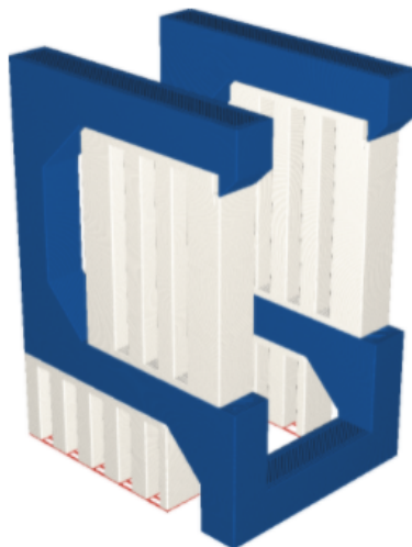
Figura 5.6.2: A extrusora de suporte da primeira camada é indicada em vermelho.
