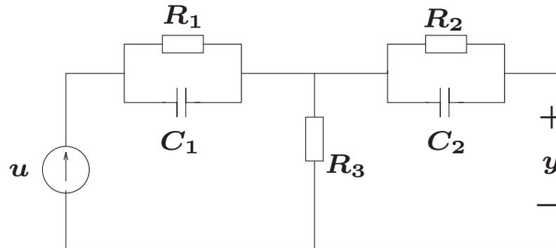
Definem-se as variáveis de estado como sendo  $v_{C_1}$  e  $v_{C_2}$
