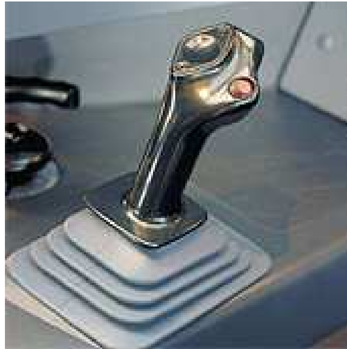
Detalhe do joystick do Airbus A380 - Fly-by-wire
