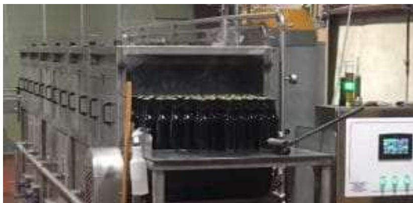
Túnel de pasteurização de cervejas. Fonte: www.smrtmachine.com
