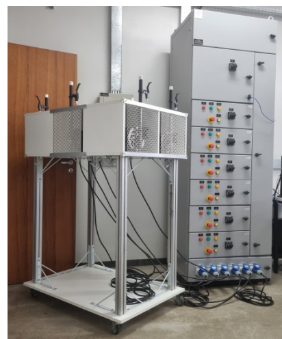
Figura 5 – Vista conjunta do CCM da sala 1205 do Lab. Automação (direita) e do módulo contendo os 6 motores trifásicos (esquerda).
