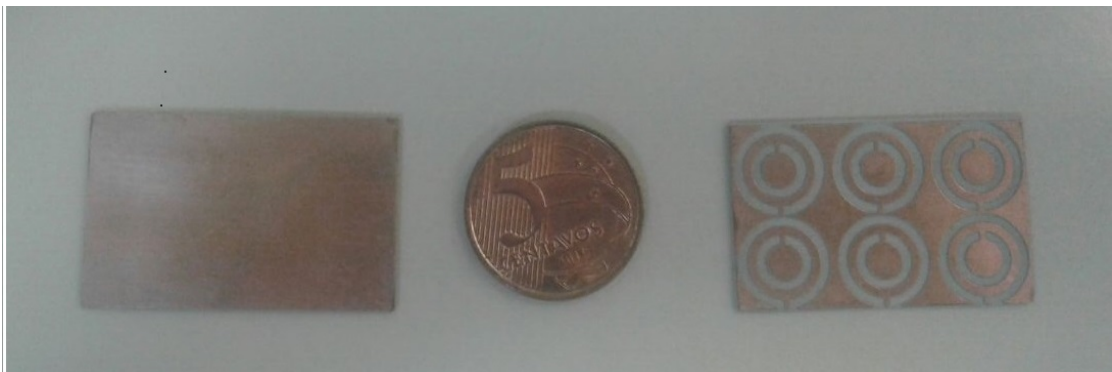
Figura 4.2: Protótipos das etiquetas RFID inicial e final, vista inferior (plano terra).
