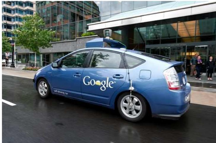
Figura 1.2: Carro Autônomo da Google. Toyota Prius adaptado para movimentar-se sem a necessidade de um motorista [Comogam, 2013]
