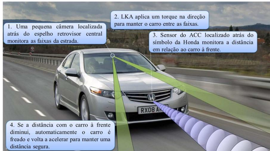
Figura 2.1: Exemplo de ADAS da Honda, adaptado de [Autoevolution, 2013]
