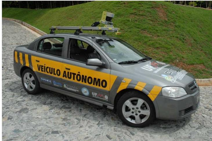
Figura 1.3: Carro Autônomo Desenvolvido na UFMG (CADU) - Automóvel comercial de modelo Chevrolet Astra Sedan 2003 adaptado para adquirir características de um robô autônomo.
