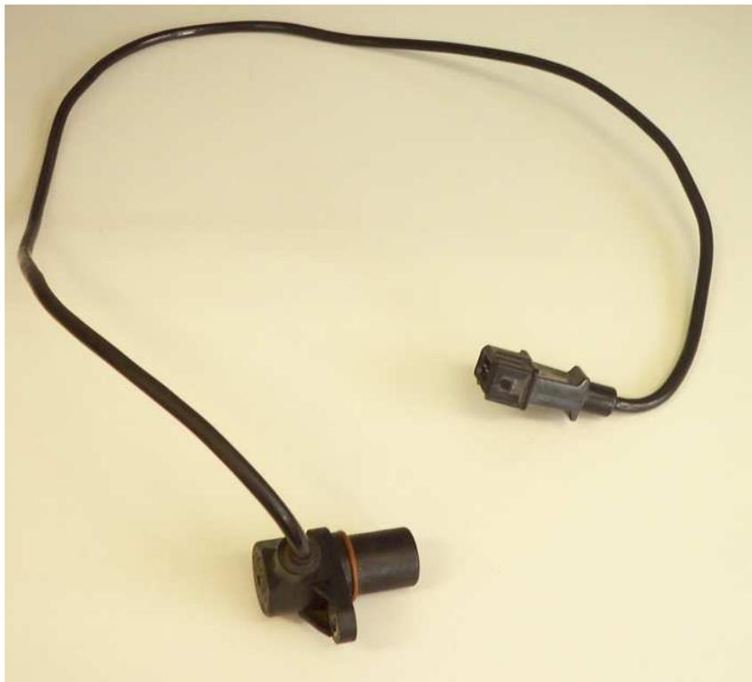
Figura B.2: Sensor de rotação do motor do CADU.
