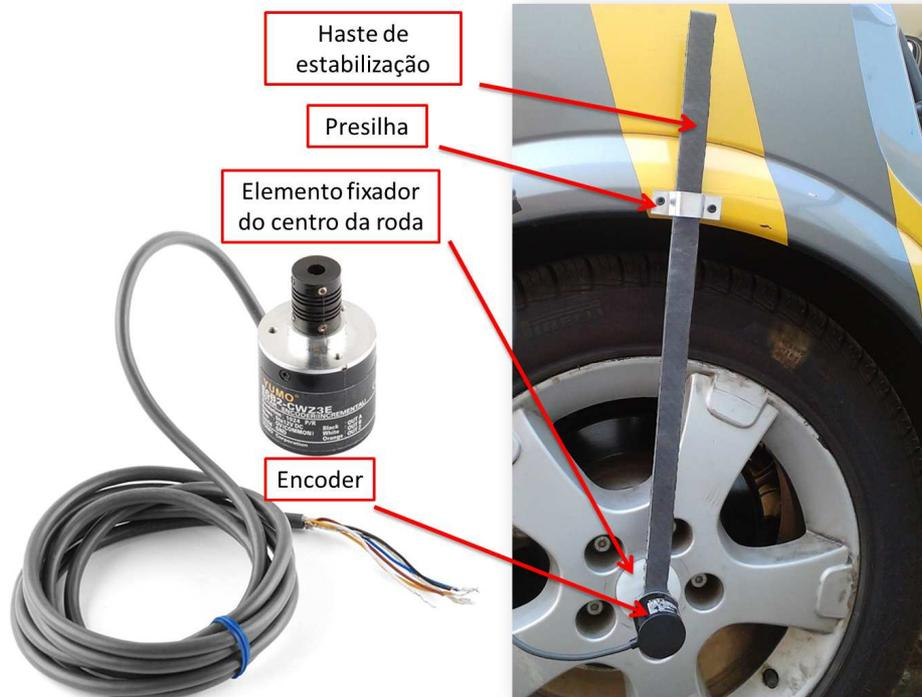
Figura A.1: Fotografia do encoder YUMO E6B2-CWZ3E e a sua forma de fixação na roda traseira direita do CADU.
